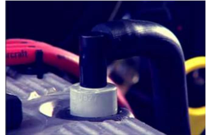
La válvula PCV, se aloja en la tapa de la cabeza del motor y funciona como un **sistema de ventilación del cárter** y como un mecanismo de control de contaminación. Es activada por el vacío del motor y controla la velocidad de ventilación de manera que los vapores se eliminan con la misma velocidad que se generan, esto evita su acumulación dentro del motor.
