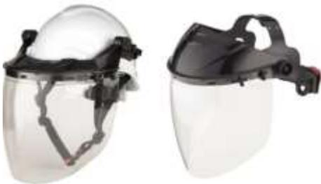
Pantallas faciales contra el arco eléctrico de cortocircuito. Deben tener un espesor mínimo de 1,2mm, una altura de visión libre en sentido vertical de 150 mm. como mínimo y una clase de protección de 2-1,2 o 3-1,2. El número 8 es el símbolo de marcado que indica la solidez frente al arco eléctrico de cortocircuito.
